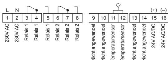
Die Relais-Ausgänge sind im Alarmbetrieb/ spannungslosen Zustand dargestellt. Max 5A, 250V
